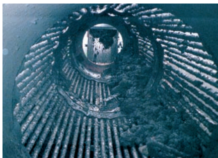
高粘性材料を選別中の機内の様子
